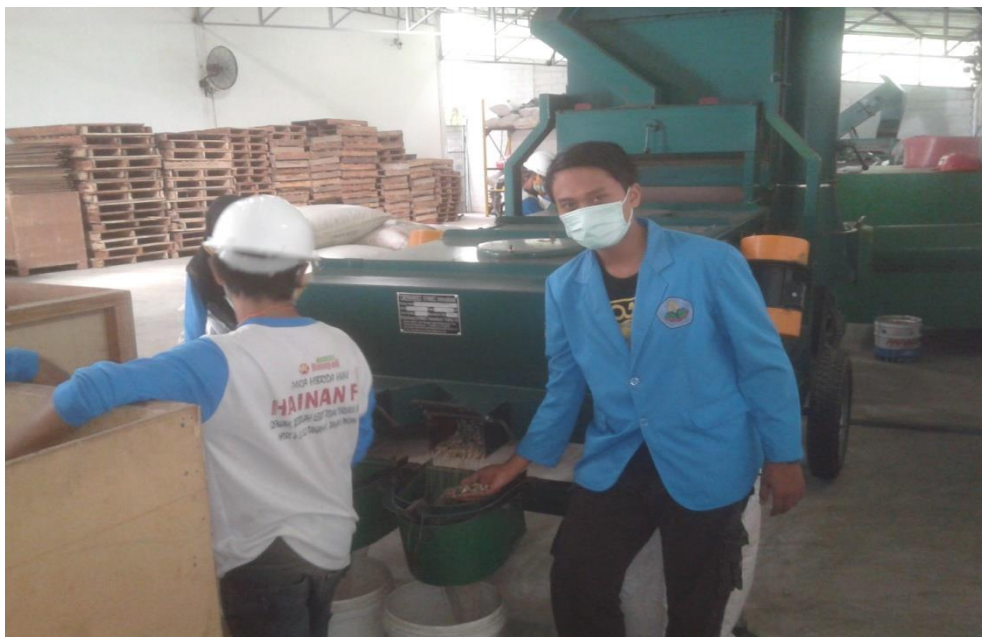
Gambar Pemrosesan Benih dengan Menggunakan Cleaning Machine untuk Benih Besar
