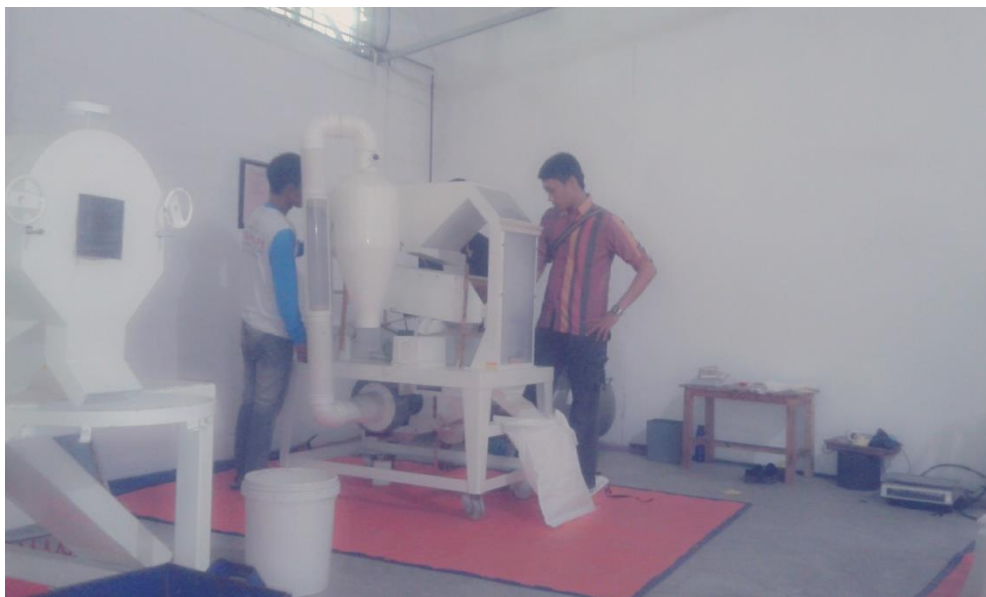
Gambar Pemrosesan Benih dengan Menggunakan Cleaning Machine untuk Benih Kecil
