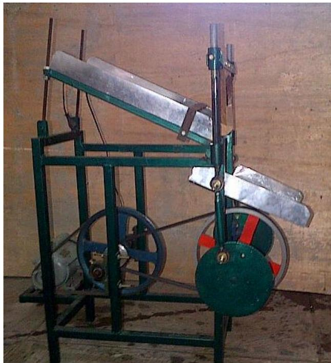
Gambar 4.1 Mesin Perajang Singkong Menggunakan Papan Pisau Vertikal dengan Mekanisme Kerja Engkol Peluncur
