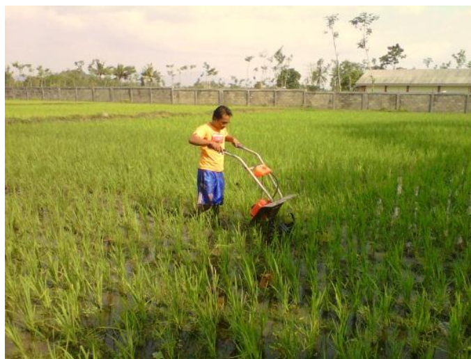
Gambar 4.3 Pengujian Mesin Penyiang Gulma di Lahan Sawah
