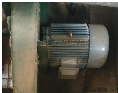
Gambar 4.3 Motor listrik Yuema tipe YU-132S
