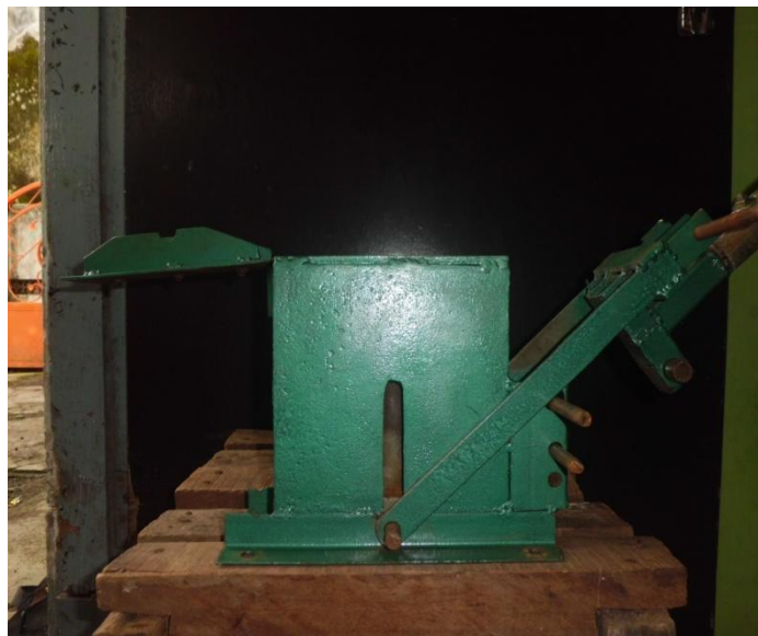
Gambar 4.1. Alat Pencetak Media Tanam (Log Cocopeat ) Metode Dingin dengan Sistem Tekan Manual.
