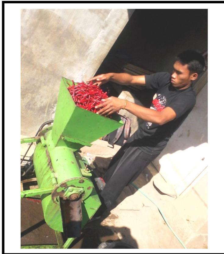
Gambar 3.13 Ekstraksi benih menggunakan mesin
