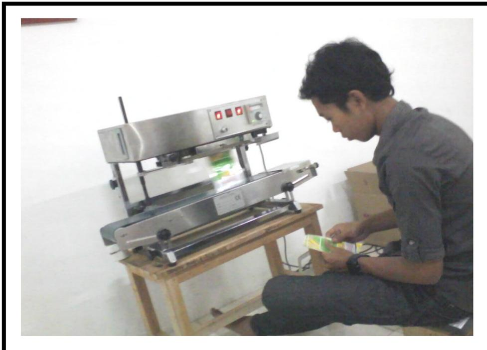
Gambar 3.21 Mengepres Kemasan dengan Mesin Sealer
