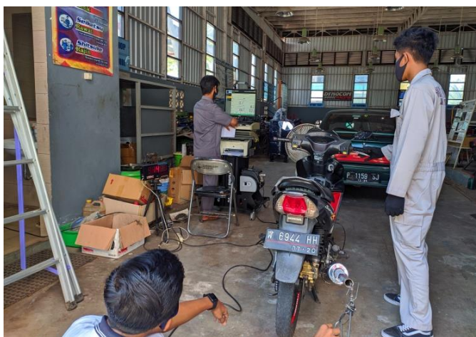
Gambar 4. 5 Foto Proses Pengambilan Data Emisi Gas Buang (Sumber : Pribadi)
