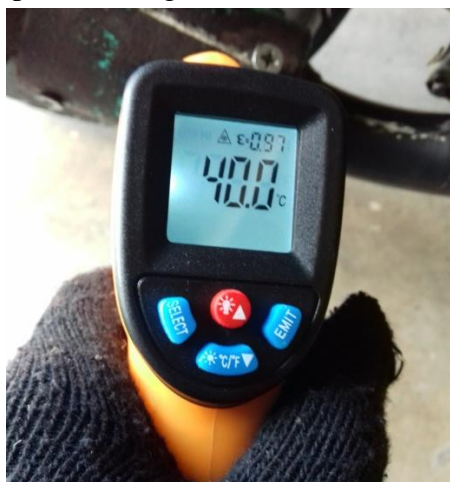
Gambar 4. 6 Pengambilan Suhu Tabung Magnet (Sumber : Pribadi)
