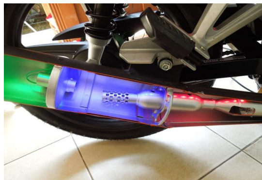
Gambar 3. 2 Sekat dalam Muffler (Sumber: Mitra, 2014)
