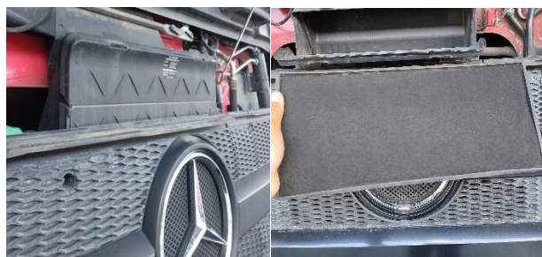
Gambar 3. 6 Pembersihan dan Filter AC (sumber: PT Gudang Garam Tbk Kediri)
