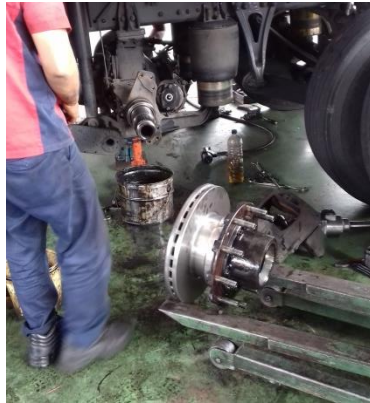
Gambar 5. 2 Pemasangan disc brake dengan turning machine Sumber: PT Gudang Garam Tbk. Kediri, 2020
