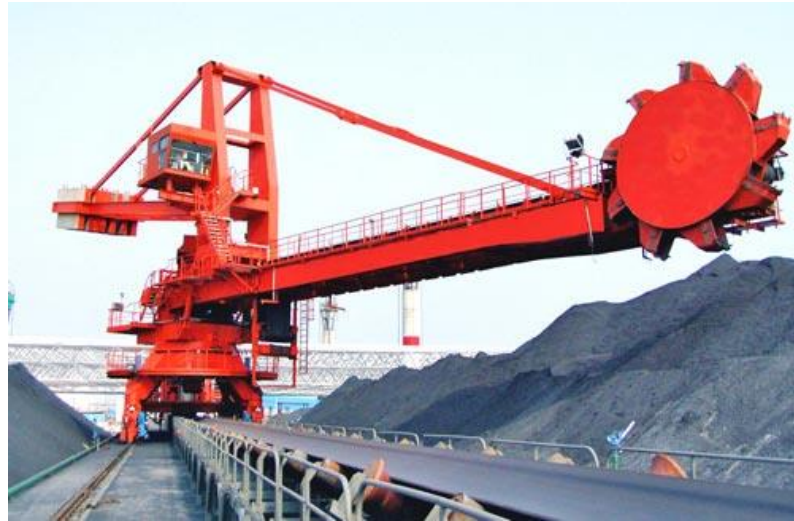
Gambar 3.8 Stacker atau Reclaimer
