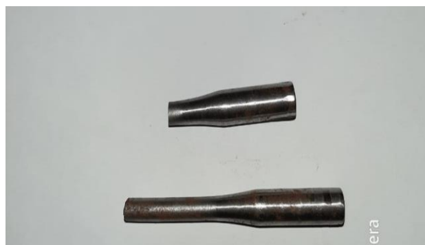
Gambar 4.11 Patahan Spesimen Tanpa Takik (Dokumen Pribadi, 2020)
