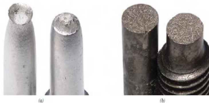
Gambar 2.4 Penampakan (a) patah ulet (cup and cone) pada aluminium, dan (b) patah getas pada mild steel (Pratama, 2016)
