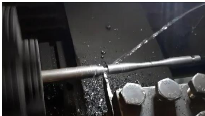
Gambar 4.4 Proses Pengaliran Air pada Pembubutan (Dokumen Pribadi, 2020)
