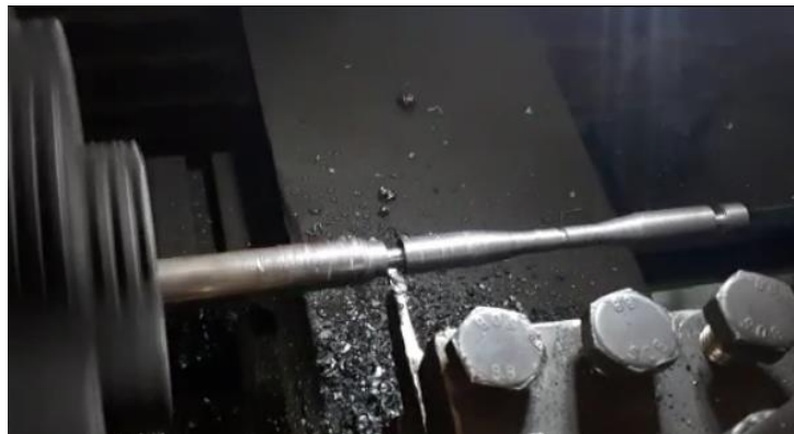
Gambar 4.2 Proses Pembuatan Spesimen Tanpa Takik (Dokumen Pribadi, 2020)
