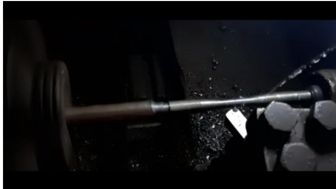
Gambar 4.3 Proses Pembuatan Spesimen dengan Takik (Dokumen Pribadi, 2020)
