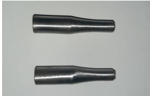
Gambar 4.9 Patahan Spesimen Bertakik (Dokumen Probadi, 2020)
