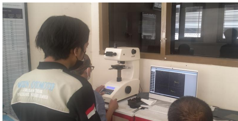
Lampiran 5. Pengujian Vikers Hardness Tess
