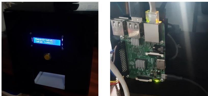
Gambar 4.2 LCD dan Raspberry pi
