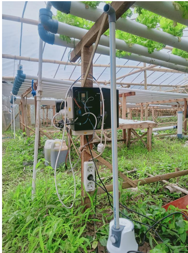
Gambar 4.11 Implementasi Alat Sistem Irigasi Pintar Berbasis IoT (Sumber: Dokumen Pribadi)
