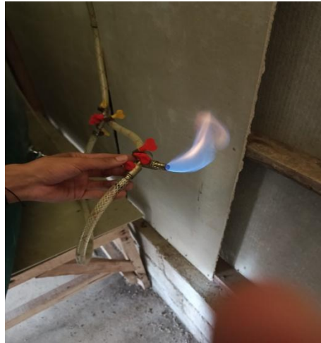
Gambar 2. 1 Nyala Api Hasil Pembakaran Biogas
