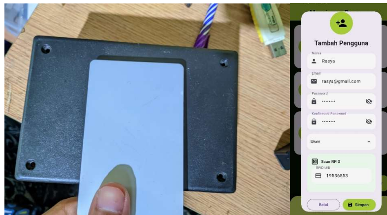
Gambar 4. 11 Pendaftaran Kartu RFID (Sumber : Dokumentasi Pribadi)
