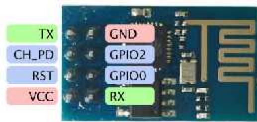
Gambar 4.5.2 Pin pada Esp8266
