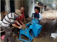
Gambar 4. Proses pemotongan limbah serei wangi menggunakan mesin chopper
