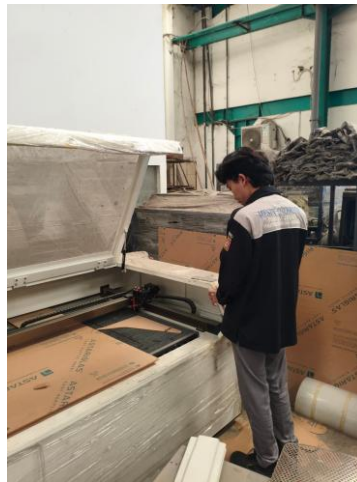
Gambar 3.5 Pemotongan dengan Mesin CO2 Laser 1309
