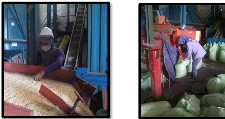
Gambar 4.4 Kegiatan pengayakan benih jagung ( Gravity ) pada PT. Asian Hybrid Seed Technologies Indonesia
