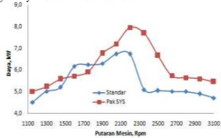
Gambar 9. Hubungan daya terhadap variasi putaran mesin
