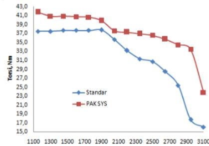
Gambar 8. Hubungan torsi terhadap variasi putaran mesin
