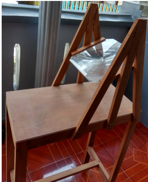
Gambar 4.1 Hasil rancangan kompor tenaga surya dengan konsentrator lensa fresnel
