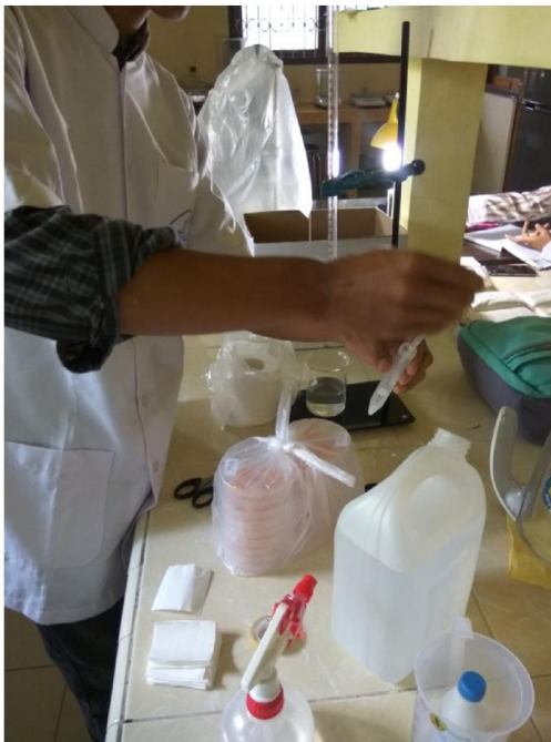
Pembuatan larutan \text{Pb}(\text{C}_2\text{H}_3\text{O}_2)_2 .
