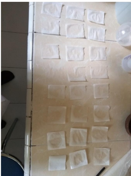
Penetesan kertas saring dengan \text{Pb}(\text{C}_2\text{H}_3\text{O}_2)_2 .
