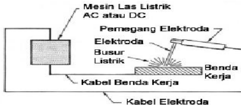
Gambar 2.2 Skema dasar las busur listrik.
