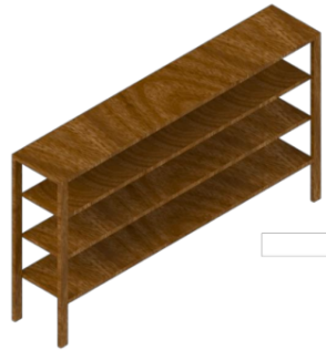
Gambar 2. Desain Rak Jamur Tiram
