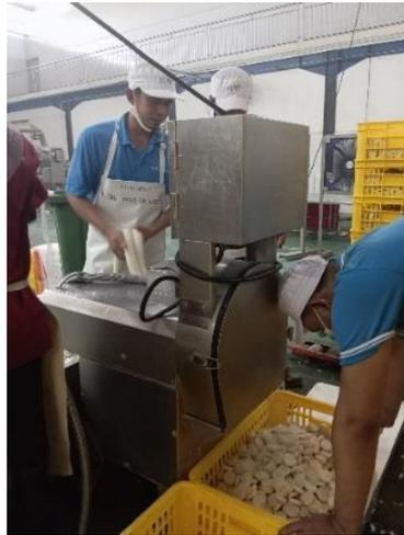
Gambar 3.19 Mesin Pemotong Scallop
