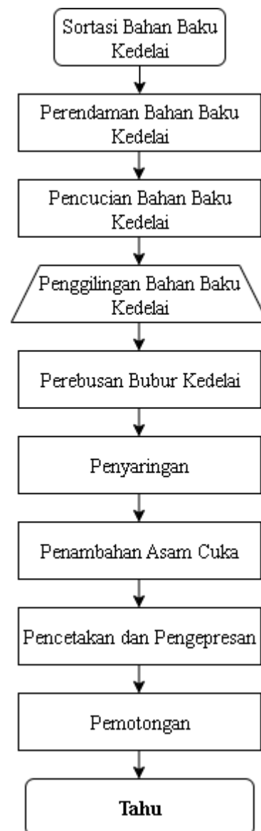
Gambar 4. 1 Diagram Alir Metode Pembuatan Tahu Putih di UD Tahu Bangkiet
