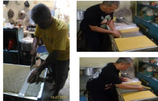
Gambar 1. Proses Pemotongan Suwar-Suwir dari Ukuran yang besar ke ukuran yang sedang dan menggunakan alat pengukur yang sudah dibuat dengan desain dan ukuran yang diinginkan.
