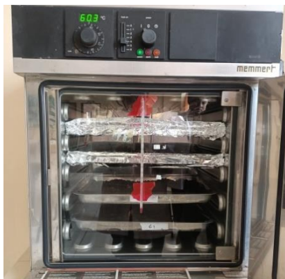
Gambar 11. Endapan kemudian dimasukkan ke dalam oven suhu 60° selama 48 jam.
