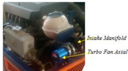
Gambar 4. Pemasangan Turbo Fan Aksial
