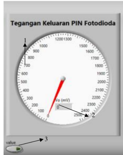
Gambar 7. Jendela front panel LabVIEW untuk pembacaan tegangan keluaran
