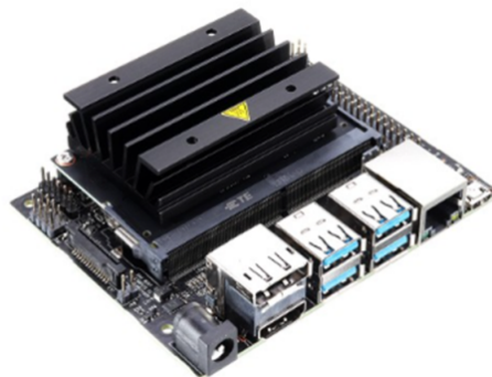
Gambar 9.2: Board Jetson Nano yang memiliki GPU sebagai Prosesor Tambahan.
