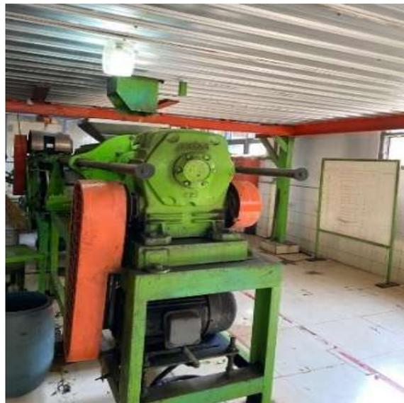
Gambar 3. 20 Mesin *Rotorvane*
