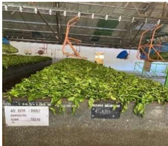
Gambar 3. 18 Letak *Withering Trough*
