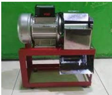
**Gambar 1.2** Mesin Pamarut kelapa
