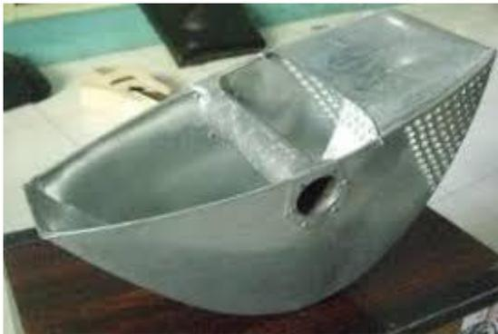
**Gambar 1.2 Alat Penyiram Bawang Merah Manual**
