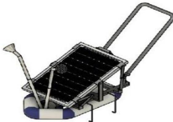
**Gambar 1.5 Alat penyiraman bawang merah menggunakan solar panel dan baterai**
