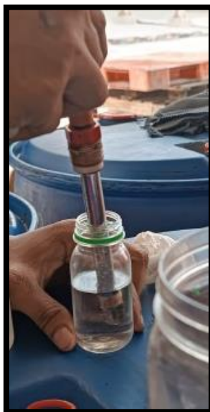
Gambar 13. Kalibrasi pH meter di Plant Surfaktan
