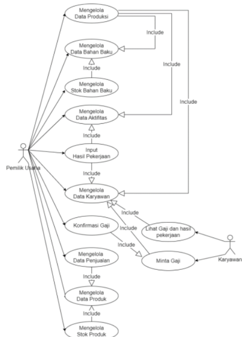
Gambar 2. Use Case Diagram Pengguna Sistem dan Hak Aksesnya
