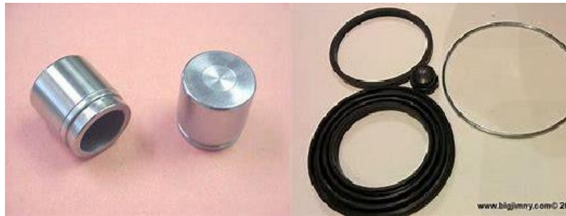
Gambar 4.9 Piston dan seal piston
