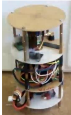
Gambar 2. Bentuk fisik payload / muatan roket
