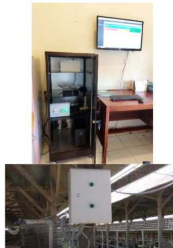
Gambar 4. Hasil instalasi sistem smart egg counting untuk monitoring secara real-time
