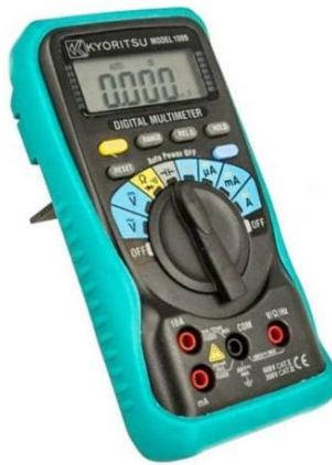
Gambar 5.7 AVOMeter Digital (Sumber: Alatproyek.com)
