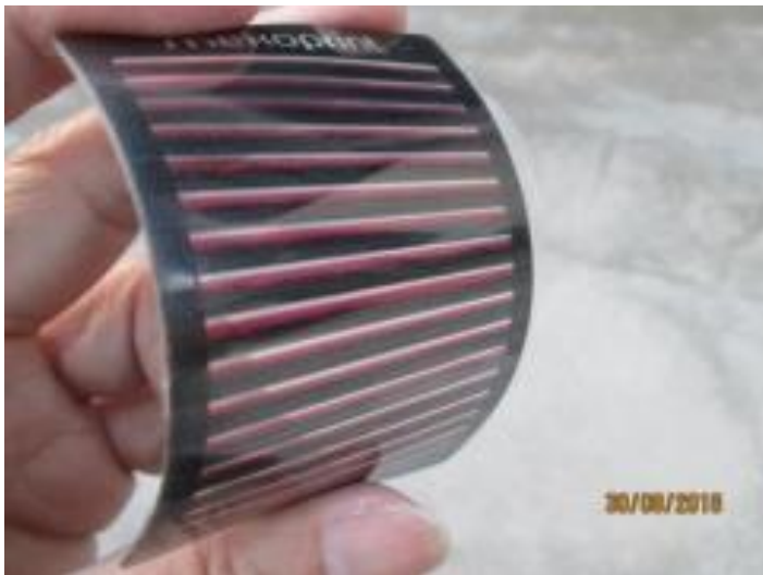
Gambar 2.9 Panel Surya OPV (Sumber: Google Images)
