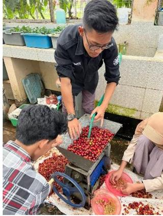
Gambar 3.10 Ekstraksi Buah Kopi Menggunakan Mesin Pulper Manual.
