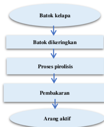
Gambar 4. Diagram alir pembuatan arang aktif
