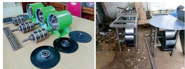
Gambar 6. Pembuatan generator mikrohidro dan turbin cross-flow
