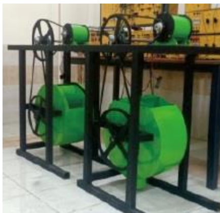
Gambar 7. Mikrohidro dengan turbin cross-flow
