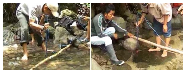
Gambar 4. Pengukuran debit aliran air
