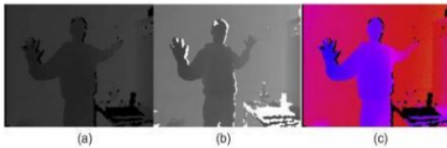
Gambar 3 Perbaikan tingkat kedalaman citra: (a) kedalaman citra asli, (b) perbaikan tingkat keabuan, (c) pemberian color depth pada aras keabuan
