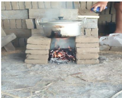
Gambar 2.1 Tungku batu bata tipe box Sumber: Dokumentasi Pribadi, 2019.
