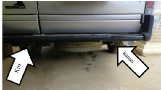
Gambar 5. Posisi penempatan sensor pada mobil MPV
