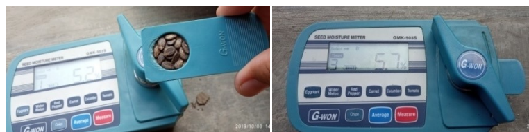
Gambar 4.28 Alat Pengujian Kadar Air Benih
