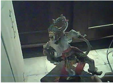
Gambar 4. Hasil foto yang ditangkap modul OV2640
