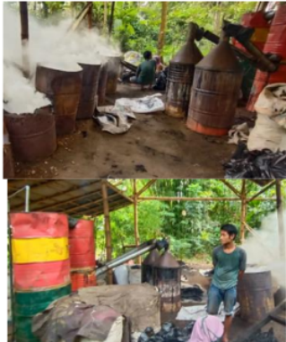
Gambar 3. Pembuatan Instalasi Asap dan Uji Operasi
