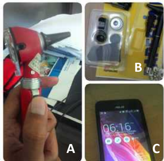
Gambar 3. A. Otoskop konvensional B. Lensa klip eksternal C. Smartphone Android™
